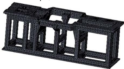
Рис.1. Конечно-элементная модель фундамента.
